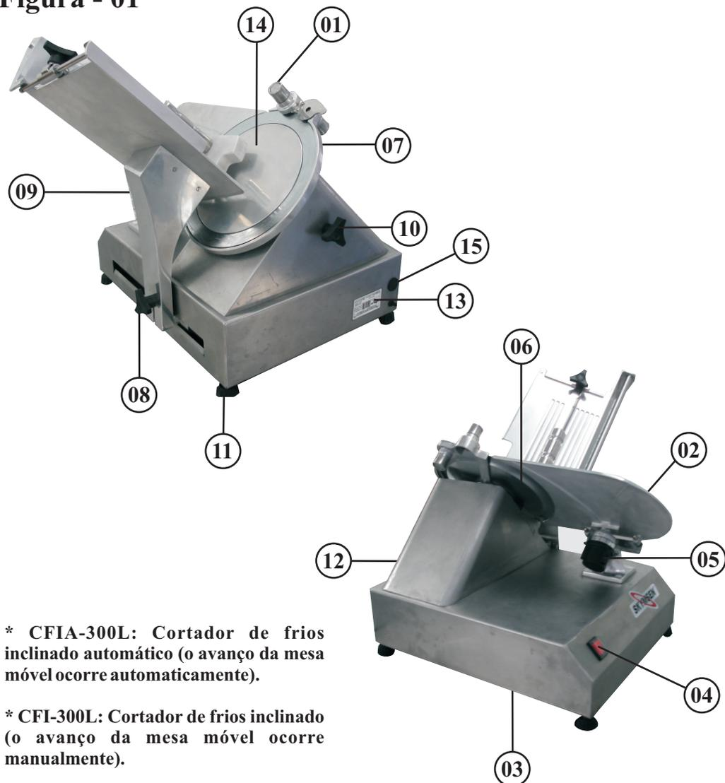
\* CFIA-300L: Cortador de frios inclinado automático (o avanço da mesa móvel ocorre automaticamente).
