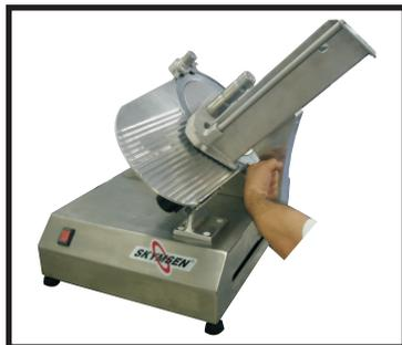
El movimiento de la mesa móvil del Modelo CFI-300L, se hace mecánicamente, usando la mano.
