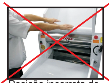
Posição incorreta de trabalho.
