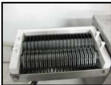
4- Após a colocação do Suporte dos pentes deve-se colocar os pentes do Kit estrogonofe, onde o Kit estrogonofe é composto por dois pentes um para o rolo cortador e outro para o rolo empurrador. O pente do rolo cortador N°01 (Fig-09) é diferenciado do pente do rolo empurrador N°02 (Fig-09) portanto deve ser acoplado junto ao rolo cortador no lado direito da máquina, e o pente do rolo empurrador deve ser acoplado do lado esquerdo da máquina.
