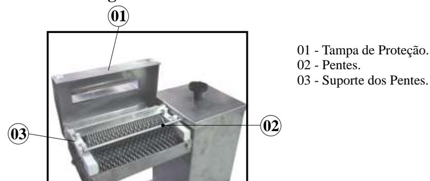
2- Após ter seguido a etapa 1 deve-se retirar os Rolos Seccionadores N°03 (Fig-06), para retirar os rolos gire o manípulo N°02 (Fig-06) até que as chavetas estejam na posição vertical conforme figura 07. Com o auxílio do Extrator dos rolos N°01 (Fig-06) remova o rolo seccionadores N°03 (Fig-06) verticalmente para cima, tomando cuidado com as lâminas Seccionadoras pois as mesmas possuem arestas cortantes.
