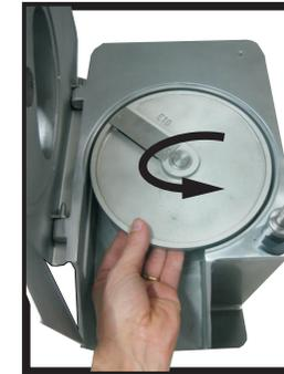
3.4.3 Segure na parte esquerda inferior da grade e puxe-a para cima, sempre cuidando com as lâminas cortantes.
