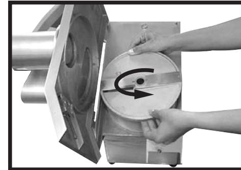
3.4.3 Agarre en la parte izquierda inferior del disco y tirelo hacia arriba, siempre cuidando las cuchillas cortantes.
