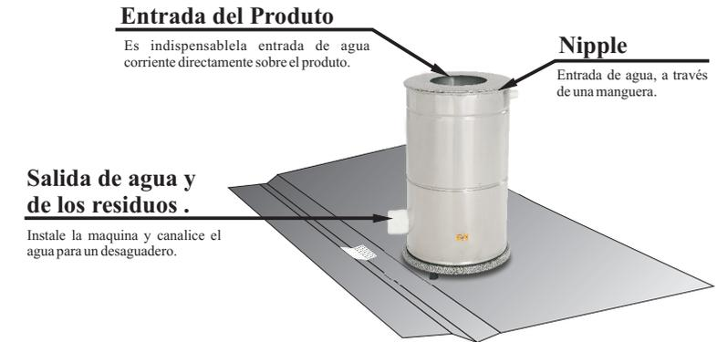
El choro de agua que entra en el equipamiento no debe ultrapasar el centro del disco abrasivo según indicado en el diseño-01 .
