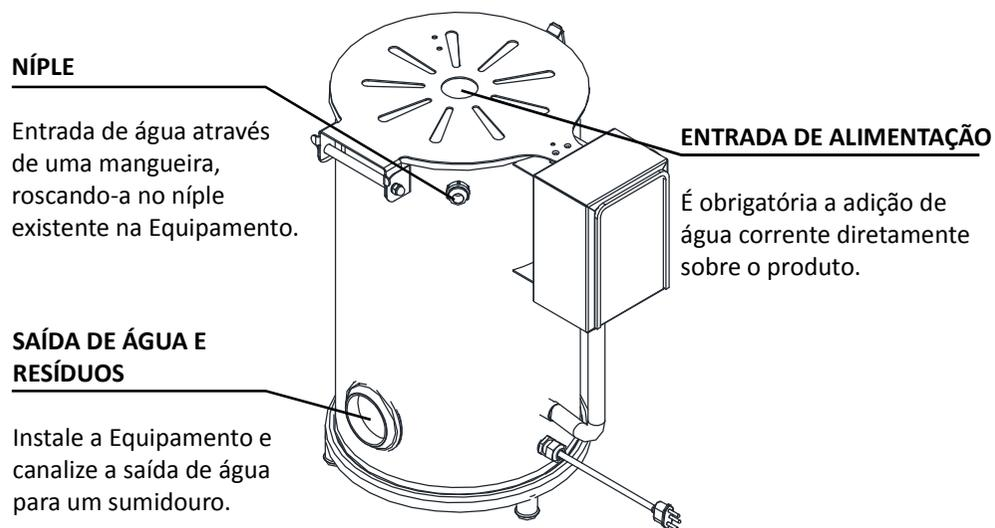
O jato d' água que entra no equipamento não deves ultrapassar o centro do disco conforme indicado na Figura 05.
