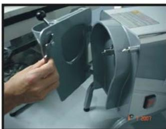
3.4.3 Retire la Boca Completa moviéndola para arriba conforme la Figura 07.
