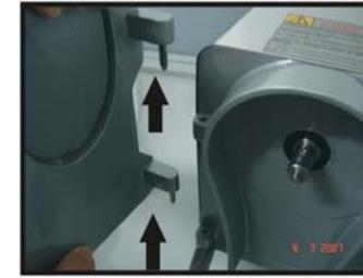
3.4.4 Para retirar la base del disco con el Disco gire el conjunto en el sentido horario sacándolo para afuera de la maquina.
