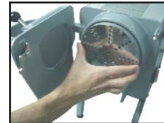
3.2.4 Cierre la Boca Completa y esté seguro de que la misma está debidamente trabada conforme la Figura 05.
