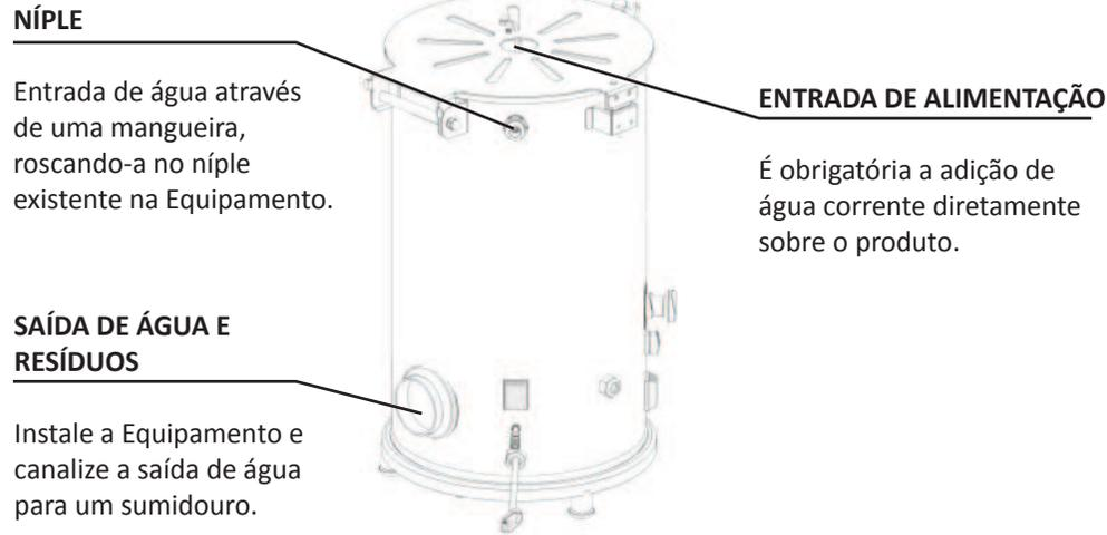
O jato d' água que entra no equipamento não devera ultrapassar o centro do disco conforme indicado na Figura 05.
