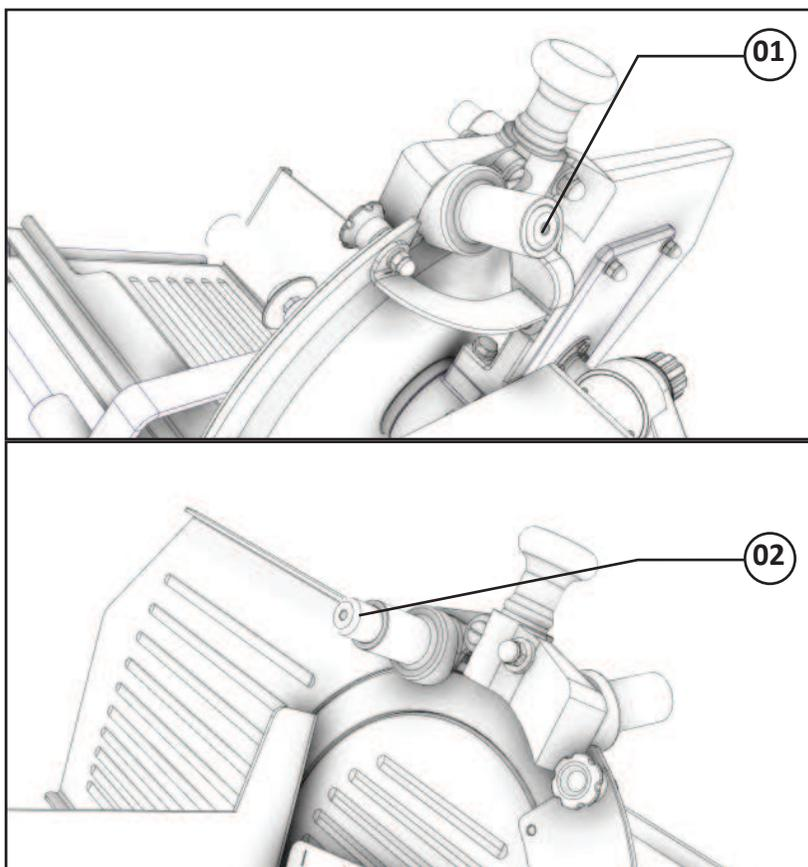
Depois de efetuado o procedimento anterior, limpe o equipamento e realize o corte de algumas fatias para teste. Se a qualidade do produto não for satisfatória (produto com rebarbas, fatias onduladas e excesso de resíduos) repita o procedimento acima até no máximo 3 vezes. Se mesmo assim o corte do produto não for satisfatório, chame a Assistência Técnica.
