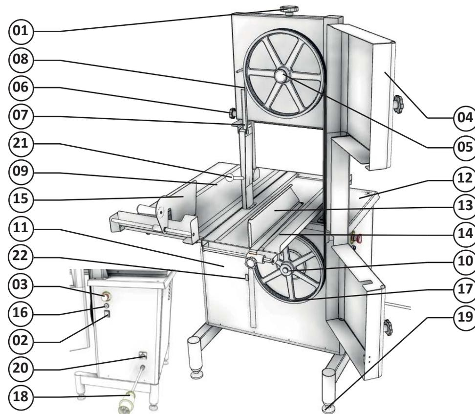
01 - Manípulo do Calibrador da Lamina
