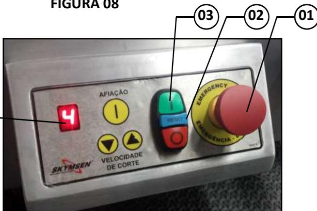
**DICA:** A velocidade de corte poderá ser alterada com o equipamento em operação, permitindo assim um melhor controle para apanhar a fatia do produto processado.
