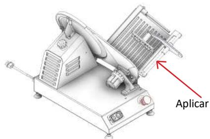
Utilizando um spray ou um pincel com o lubrificante, lubrifique a guia deslizante do apoio do produto.
