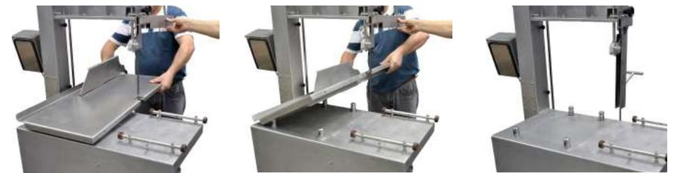
Retire el Taco de la Mesa Fija No 01 (Fig 07) levantándolo ( Figura 07)
