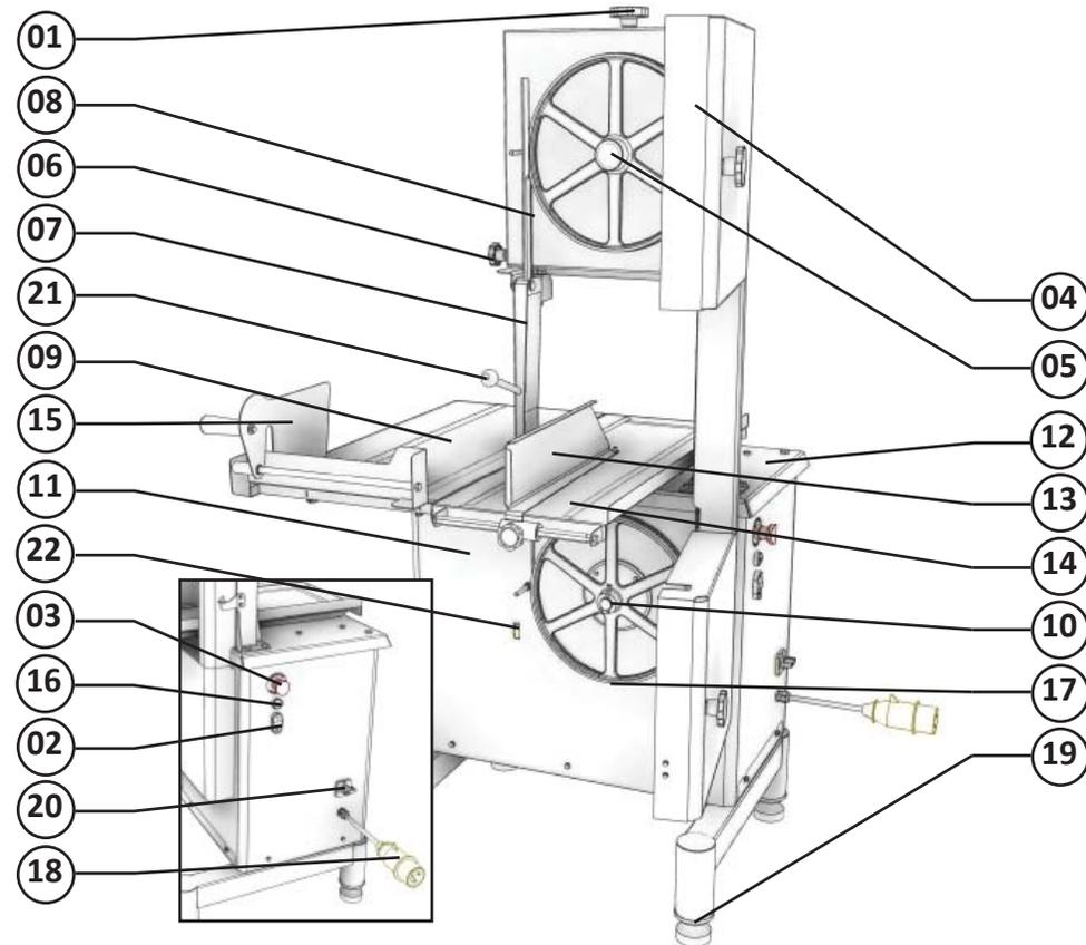
01 - Manípulo do Calibrador da Lamina
