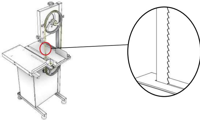
Para calibrar (esticar) a Lâmina, gire o Manipulo do Calibrador da Lâmina N° 1 (fig. 01) no sentido HORÁRIO até o mesmo parar.
