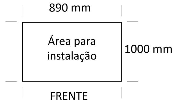
Caso o forno seja colocado em suporte de parede, certificar-se de que o mesmo suporte o peso do forno. Caso queira colocá-lo no móvel, respeitar as distâncias conforme indicado abaixo.
