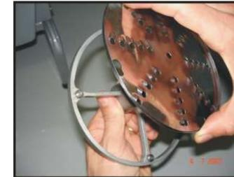
3.2.3 Encaje la base del disco con el Disco en la cámara de disco, asegurándose del perfecto encaje de la misma conforma la Figura 04.
