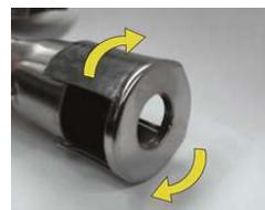
Este ajuste é feito por meio do regulador de ar nos queimadores, afrouxando o parafuso do regulador e depois abrindo ou fechando a passagem de ar.
