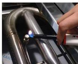
Abra a passagem de gás para o equipamento e acenda o piloto diretamente com um isqueiro na parte superior do equipamento ou ao frente, aguarde que o piloto ligue e remova a chama do isqueiro. (A ignição do piloto pode atrasar na primeira vez, até que o gás atravesse o tubo inteiro, isso é normal).
