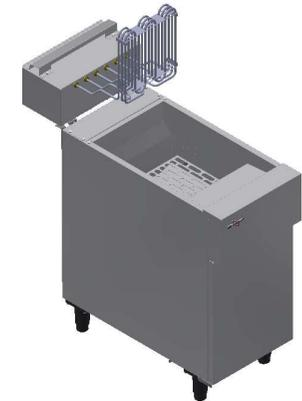
Con el depósito vacío, cierre el registro y, con jabón neutro y esponja no abrasiva, limpie el interior del depósito. Use un recipiente en el registro y el drenaje inferior para la recojo del jabón.
