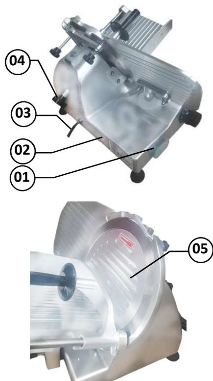
⚠ **Nunca faça limpeza com o equipamento ligado à rede elétrica, para tanto retire o plugue da tomada. Antes de retirar a Proteção Frontal do Disco (Item 05 Fig.: 6), certifique-se da completa parada do disco.**
