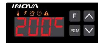
As teclas ^ v são usadas para aumentar / diminuir o valor da temperatura do óleo até 200 °C (valor máximo).
