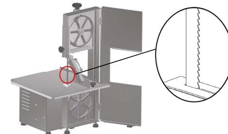
Para calibrar (esticar) a Lâmina N° 12 (Fig. 01), gire o Manipulo Calibrador da Lâmina N° 01 (Fig. 01) até o final.
