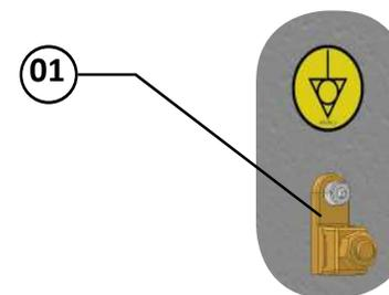
Este equipamento é fornecido com sistema de segurança que impede o motor de girar no sentido contrário ao especificado pela fábrica.
