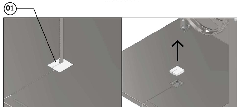
Gire o Manípulo do Calibrador da Lâmina N°01 (Fig. 05) no sentido anti-horário até que a lâmina N°02 (Fig. 05) esteja livre para ser removida.
