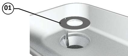
O bocal de descarga possui uma proteção física que impede o acesso às áreas de perigo.
