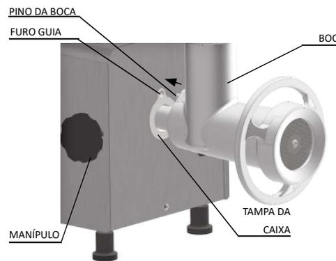
**⚠ Antes de ligar a máquina, certifique-se que o PINO DA BOCA esteja perfeitamente encaixado no FURO GUIA da TAMPA DA CAIXA, e o MANÍPULO devidamente apertado. Caso o equipamento for ligado sem que a BOCA esteja devidamente encaixada e apertada, a BOCA poderá girar, causando danos irreparáveis ao equipamento, bem como ferir o operador.**
