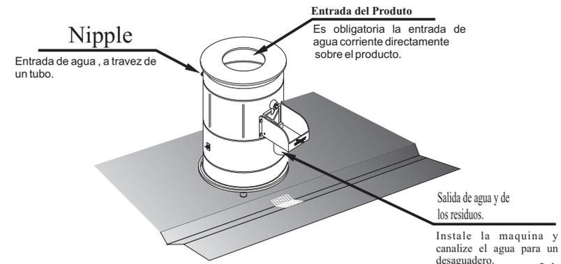
El chorro de agua que entra en el equipamiento no debe ultrapasar el centro del disco abrasivo según indicado en el diseño-01.
