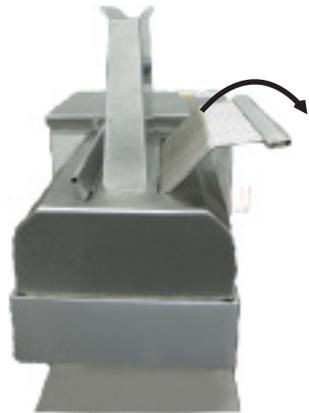
**⚠ Eliminar un pente a la vez. Siempre hacer esta operación con la tapa de protección montado en el equipo como se ilustra en las figuras 03 y 04.**
