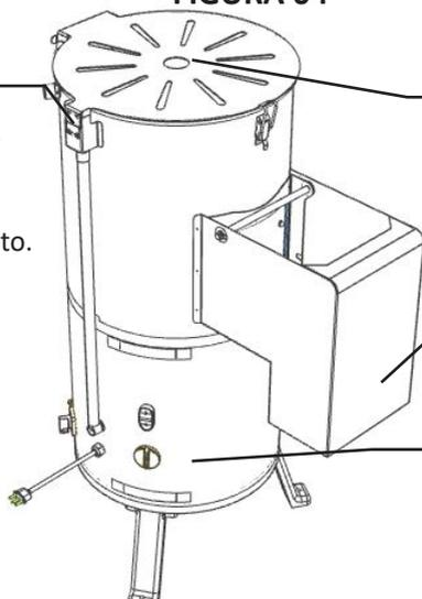
O jato de água que entra no equipamento não deveria ultrapassar o centro do Disco Abrasivo N° 07 (Fig. 01) conforme indicado na Figura 05.
