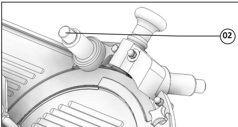
Depois de efetuado o procedimento anterior, limpe o equipamento e realize o corte de algumas fatias para teste. Se a qualidade do produto não for satisfatória (produto com rebarbas, fatias onduladas e excesso de resíduos) repita o procedimento acima até no máximo 3 vezes. Se mesmo assim o corte do produto não for satisfatório, chame a Assistência Técnica.
