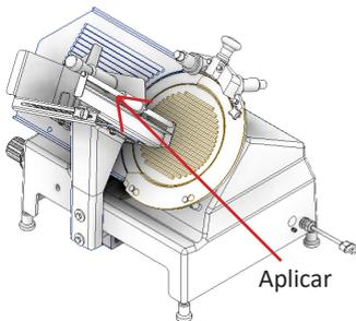
Utilizando um spray ou um pincel com o lubrificante, lubrifique a guia deslizante do apoio do produto.
