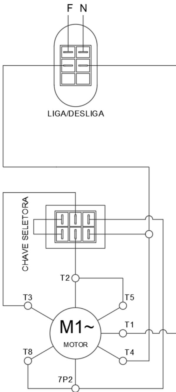
NOTA: Para fazer a inversão do sentido de rotação do motor, troque o fio T5 pelo fio T8.
