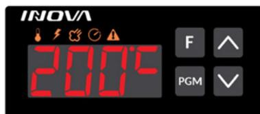
As teclas ^ v são usadas para aumentar / diminuir o valor da temperatura do óleo até 200 °C (valor máximo).
