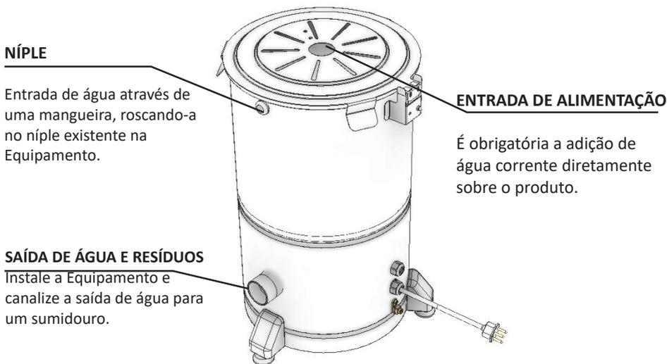
O jato d' água que entra no equipamento não devesa ultrapassar o centro do disco conforme indicado na Figura 05.
