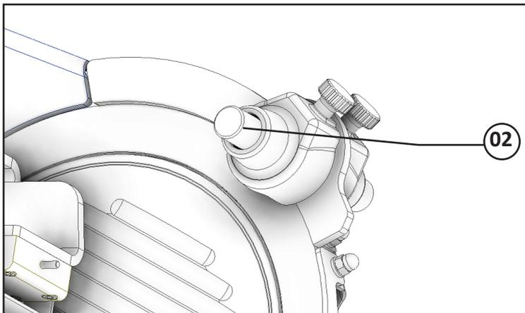
Depois de efetuado o procedimento anterior, limpe o equipamento e realize o corte de algumas fatias para teste. Se a qualidade do produto não for satisfatória (produto com rebarbas, fatias onduladas e excesso de resíduos) repita o procedimento acima até no máximo 3 vezes. Se mesmo assim o corte do produto não for satisfatório, chame a Assistência Técnica.
