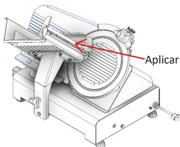
Utilizando um spray ou um pincel com o lubrificante, lubrifique a guia deslizante do apoio do produto.
