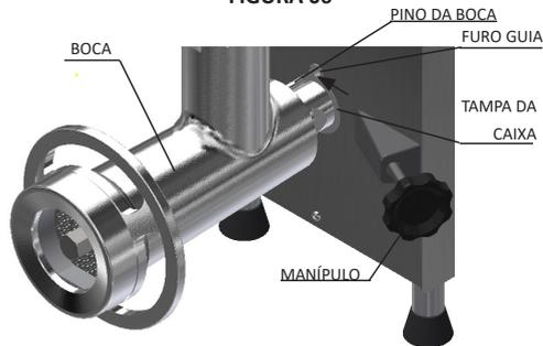
**⚠ Antes de ligar a máquina, certifique-se que o PINO DA BOCA esteja perfeitamente encaixado no FURO GUIA da TAMPA DA CAIXA, e o MANÍPULO devidamente apertado. Caso o equipamento for ligado sem que a BOCA esteja devidamente encaixada e apertada, a BOCA poderá girar, causando danos irreparáveis ao equipamento, bem como ferir o operador.**
