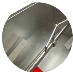
Tanque, pás e eixo fabricadas em aço inox 304
