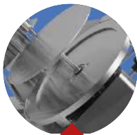
Proteção frontal do disco
